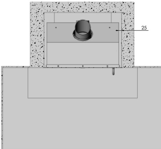
Si le poêle encastrable doit être installé dans un environnement inflammable, il est nécessaire de construire un équipement dans lequel il doit être installé. L'équipement pour le poêle doit assurer la protection de l'environnement contre la chaleur du poêle encastré, ceci à l'aide d'une protection et de la ventilation. Il existe un grand nombre de manières de construire un équipement adapté au poêle.
