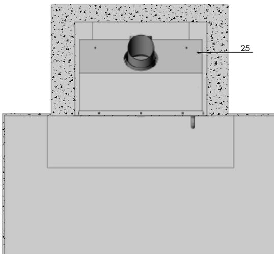
In een brandbare omgeving moet de inzethaard in een ombouw worden ondergebracht. De ombouw zal de omgeving tegen de warmteontwikkeling van de haard afschermen, en voor ventilatie zorgen. Een ombouw kan op verschillende wijzen worden geconstrueerd.
