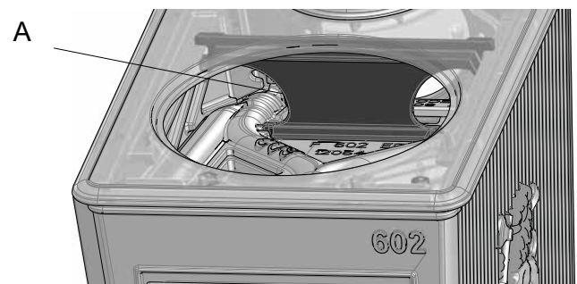
Afb. 27 De uitlaatplaat vervangen
