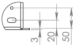
Vægbeslaget (1) placeres på væggen i den valgte højde. Der skal være en minimumsafstand på 3 cm fra gulvet til bunden af det ophængte vægbeslag.
