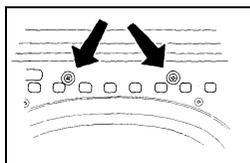
A la fin de la saison de chauffe, bouchez le conduit de fumée avec du papier journal. C'est le moment de faire un nettoyage de l'intérieur du foyer. Au besoin, remplacez les cordons d'étanchéité de la porte et mastiquez d'éventuelles fentes. Pour un nettoyage approfondi déposez également le déflecteur suspendu dans la partie supérieure du corps de chauffe.
