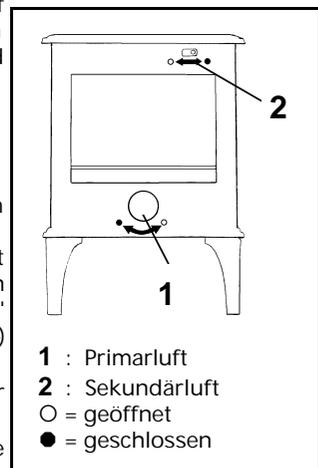
Luftschieber vollständig auf. Sehen Sie sich auf der nebenstehenden Abbildung die Funktionsweise der Luftschieber an.
