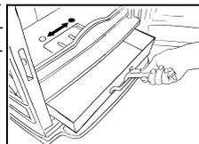
Van hout hebt u relatief weinig assen en is het niet nodig uw toestel elke keer te ontassen, het stoken van hout in een asbed geeft overigens een betere verbranding. Bij kolenstook moet regelmatig ontast worden en de aslade tijdig geleidigd worden. De assen mogen de onderzijde van het stookrooster NOOIT raken.
