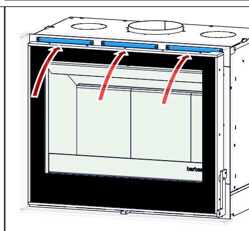
2. Bevestig om de drie convectieluchtuitlatopeningen te sluiten de drie metalen sluitstripjes met de schroeven op het toestel.
