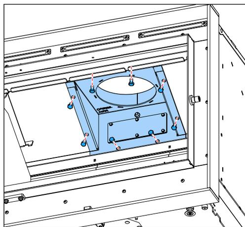
10. Verwijder voorzichtig de rookkanaalpijpconnector. Controleer of de pakking op de rookkanaalpijpconnector niet is beschadigd. Vervang een beschadigde pakking.
