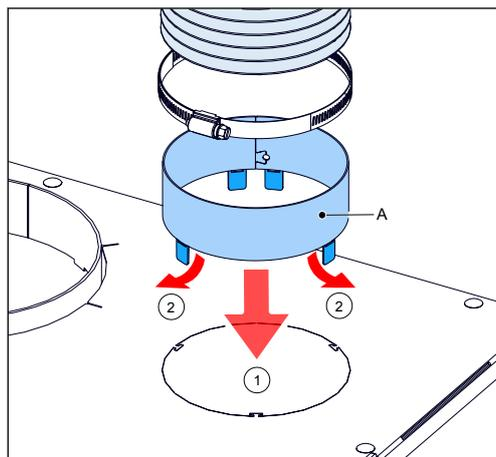
4. Sluit de flexibele aluminium pijpen (C) op de kraagringen aan. Gebruik hierbij een slangklem (B).
