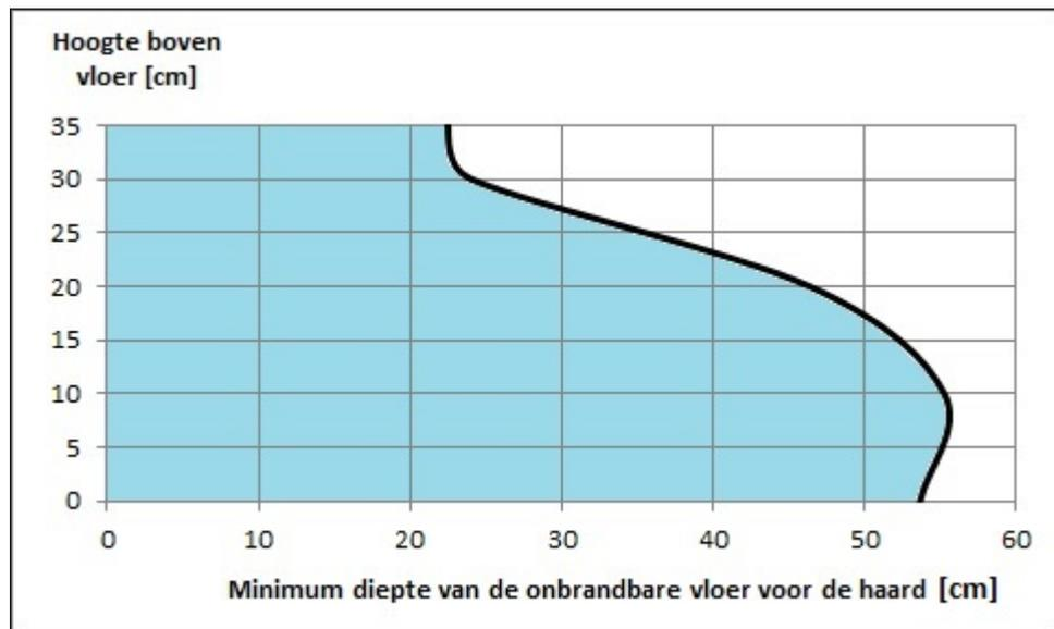
De niet-brandbare vloerplaat moet in de breedte minimaal 150 mm aan beide zijden van het toestel uitsteken.
