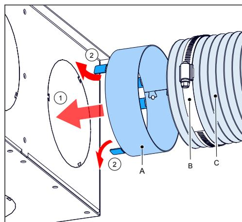
5. Sluit een flexibele aluminium pijp (C) op de kraagring aan. Gebruik hierbij een slangklem (B).
