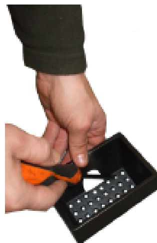
Fig. 34 - het schoonmaken van de vuurpot
