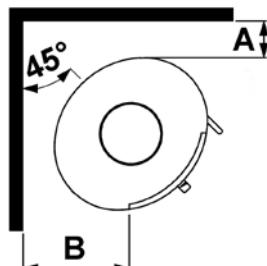
Compte tenu de la circulation de la chaleur, du nettoyage et éventuellement du nettoyage de l'intérieur du poêle, la distance recommandée au mur est de 10 à 15 cm. La tapisserie sur les murs n'est normalement pas considérée comme matériau inflammable.
