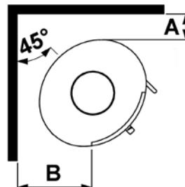
Met het oog op de warmtecirculatie en de interne en externe reiniging van de kachel raden wij u aan de kachel op minimaal 10-15 cm afstand van metselwerk te plaatsen. Normaal gesproken wordt een laag behang op een stenen wand als niet-brandbaar materiaal beschouwd.
