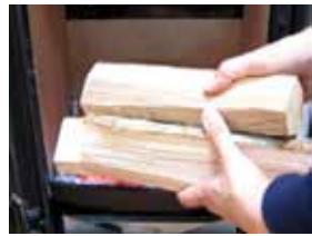
7. Wanneer de luchttoevoer maximaal is geopend en het deurtje wordt gesloten, brandt de nieuwe hoeveelheid hout binnen enkele minuten.
