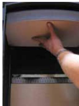
6. Après un nettoyage, assurez-vous que les chicanes pour la fumée et les briques sont à nouveau correctement montées avant d'allumer votre poêle.
