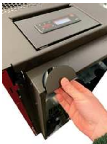
Fig. 64 - De dop verwijderen
