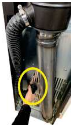
Fig. 50 - Flexibele buis invoegen
