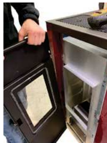
Fig. 24 - Verwijdering van de deur 3
