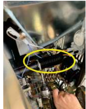
Fig. 51 - Flexibele buis aansluiten
