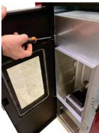
Fig. 22 - Verwijdering van de deur 1
