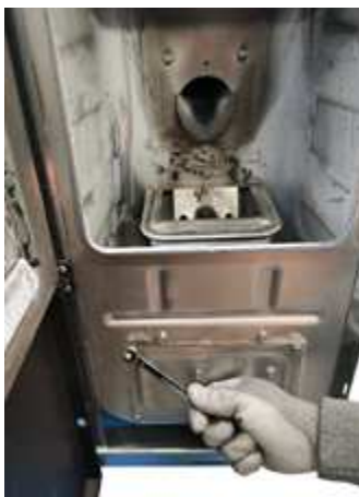
Fig. 80 - Verwijder de schroeven
