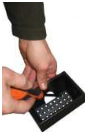
Fig. 34 - het schoonmaken van de vuurpot
