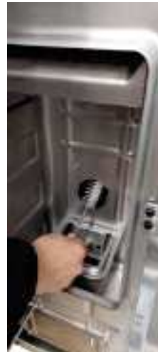
Fig. 36 - Reiniging met flessenwisser
