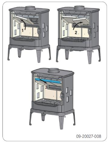
Volgorde inbrengen van de RVS-vlamplaten:
