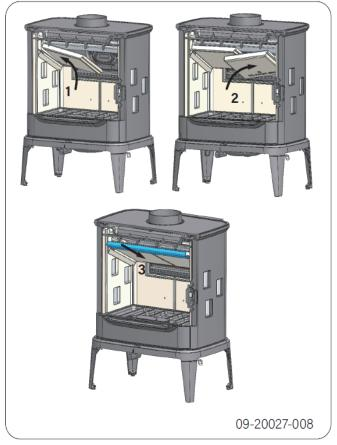
Rekkefølgen på innsetting av ledeplater i rustfritt stål:
