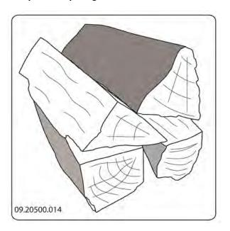
Bij een compacte stapeling verbrandt het hout langzamer omdat de zuurstof maar enkele stukken hout kan bereiken. Gebruik een compacte stapeling als u langer wilt stoken.
