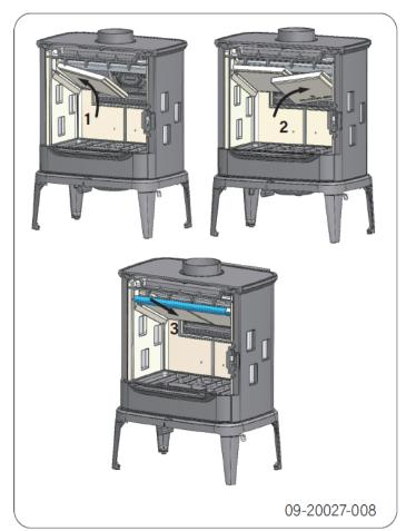
Orden de colocación de la placa de llama de vermiculita:
