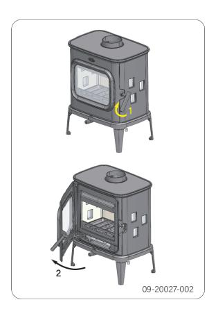
La estufa incluye un soporte para la empuñadura (4) que se puede fijar debajo de una pata delantera con una tuerca hexagonal adicional también incluida (5).
