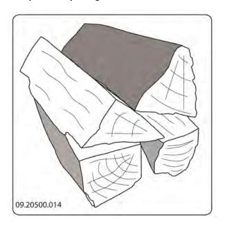
Bei einer kompakten Stapelung verbrennt das Holz langsamer, da der Sauerstoff zunächst nur einzelne Holzstücke erreichen kann. Stapeln Sie das Holz kompakt, wenn Sie länger heizen möchten.
