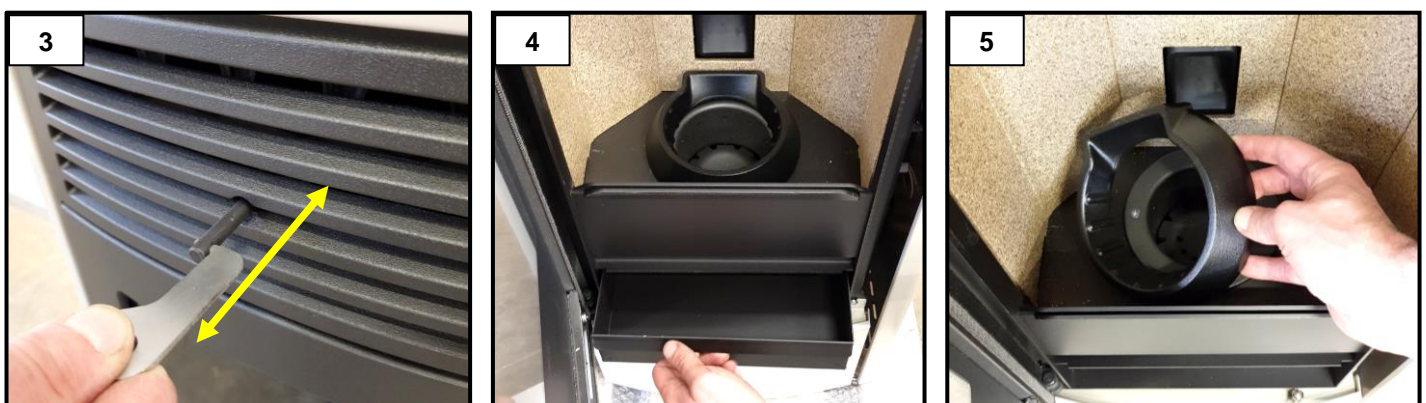
Flammenverteiler gemäß Abbildung entfernen (Abb. 1 und 2).
